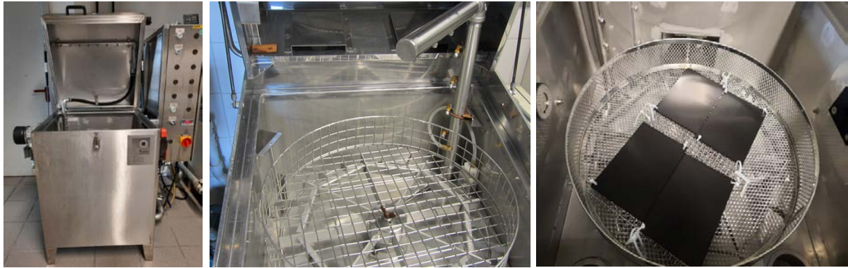
Abbildung 1: Reinigung von Plattenmaterial in der Powerwash-Laboranlage
