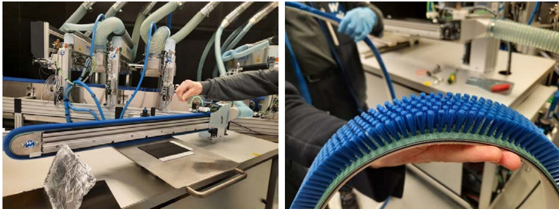
Abbildung 3: Reinigung von Plattenmaterial mit Schwertbürste
