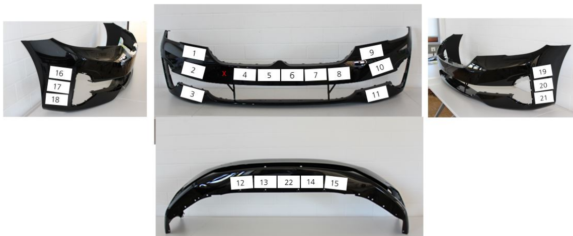
Abbildung 6: Stoßfänger und Entnahmestellen für Teilproben
