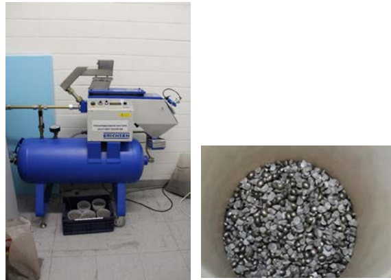
Abbildung 7: links: Multi Grit Tester 508 von Erichsen, rechts: Schlagkörper
