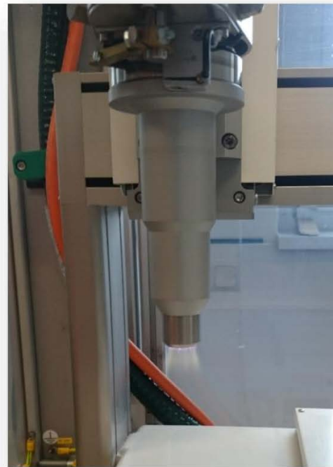
Abbildung 4: Schematischer Aufbau der Plasmadüse (links) und die genutzte Plasmadüse (rechts)
