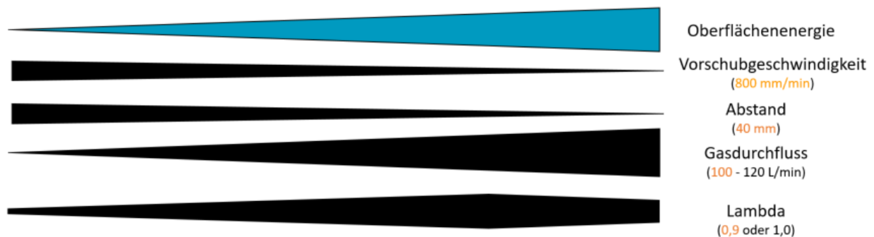
Abbildung 8: Zusammenhang zwischen der Oberflächenenergie (von links nach rechts zunehmend) und den Prozessparametern der Beflammung aus dem Vorgängerprojekt (in orange optimale Prozessparameter)
